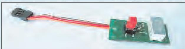
Questo modulo aggiuntivo è necessario per impostare la miscelazione integrata del piatto oscillante in tutte quelle trasmissioni sprovviste di tale miscelazione.
